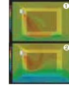
左の熱カメラ写真は、断熱・気密性能の高い①の住宅と②の断熱性能が低い住宅のエアコンの空気の流れを比較した熱カメラの写真です。①の場合は、エアコンの熱がしっかりと床まで届いていますが、②の場合は、床まで届かずに部屋の中間で急上昇しています。①の場合は、部屋全体が暖かくなっていますが、②の場合は、床が外気の寒さに影響されて、時間が経っても寒さは収まりません。これが断熱・気密性能の差です。エアコン1台で冷暖房が可能な住宅と、エネルギー消費の大きい住宅の差は、こうして生まれます。
