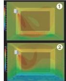
左の熱カメラ写真は、断熱・気密性能の高い①の住宅と②の断熱性能が低い住宅のエアコンの空気の流れを比較した熱カメラの写真です。①の場合は、エアコンの熱がしっかりと床まで届いていますが、②の場合は、床まで届かず部屋の中で急上昇しています。①の場合は、部屋全体が暖かくなっていきますが、②の場合は、床が外気の寒さに影響されて、時間が経っても寒さは取れません。これが断熱・気密性能の差です。エアコン1台で冷暖房が可能な住宅と、エネルギー消費の大きい住宅の差は、こうして生まれます。
