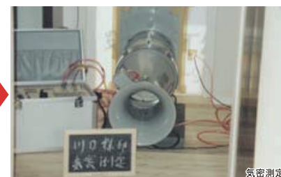
気密測定 ▲断熱施工が完了した時点で気密測定が行われる。気密測定は全棟で行われ、この気密測定で、C値（相当隙間面積）=0.5をクリア出来ない場合には、空気漏れ箇所が徹底的に調べられる。
