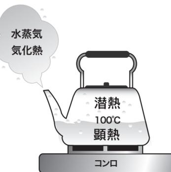
水から水蒸気へ、顕熱から潜熱に状態変化した水は、100℃以上には上昇しませんが氷蒸気として、蒸気機関車を動かす大きな力に変化します。
